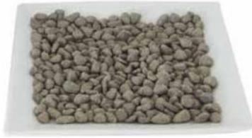
Speziell für präparative Arbeiten. Einsetzbar für Destillationen und Rückfluss in wässrigen, neutralen und basischen Lösungsmitteln, auch unter Vakuum. Wirksam in kleinsten Flüssigkeitsmengen, auch nach mehrfachen Unterbrechungen. Verhindern jedes Stossen. Naturprodukt.
