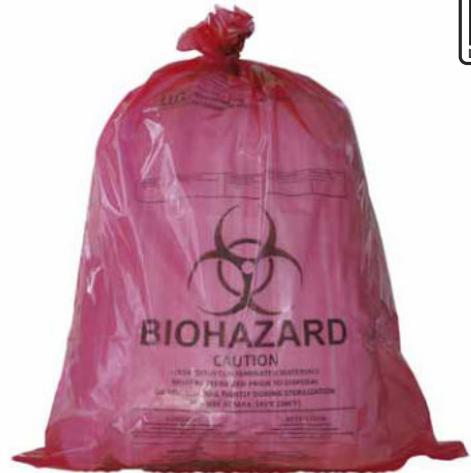
Entsorgungsbeutel Beutel mit Biohazard-Aufdruck zur sicheren Entsorgung von Laborabfällen. Zum mehrfachen Autoklavieren geeignet. Hohe Reissfestigkeit und gute Widerstandsfähigkeit gegen Stosseinwirkung. Hergestellt aus Polypropylen, mit Schriftfeld, mit Steril-Indikator. Stärke: 50 µm.
