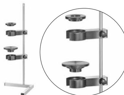
Dient zur korrekten und variablen Positionierung der Ultraschall-Wandler.
