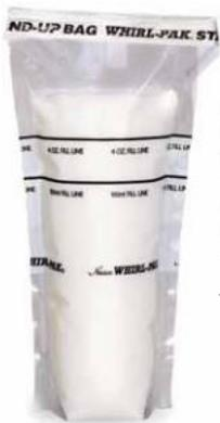
Leichteres Handling von Proben, da der Boden sich beim Befüllen aufaltet und der Beutel dann völlig frei und aufrecht stehen kann. Er steht stabil wie ein Becher oder eine Flasche, ist kostengünstiger, nicht zerbrechlich und platzsparend. Das integrierte Draht-Verschlusssystem gewährleistet die Dichtheit des Probenbeutels. Mit Beschriftungsfeld, leicht und sauber zu beschriften. Temperaturbereich: -210 bis 82 °C.
