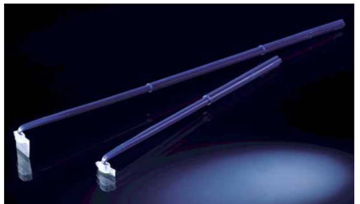
Verfügbar in zwei Grössen mit flexiblem, schwenkbarem Schaberblatt. Pyrogenfrei. Steril.
