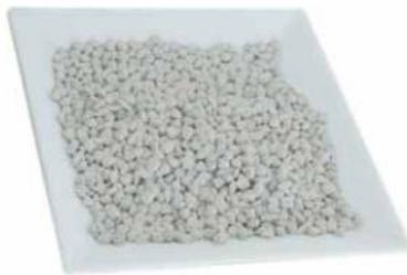
Speziell für analytische Arbeiten. Einsetzbar für Destillationen in saurem, neutralem und basischem Milieu. Für Vakuumdestillation nicht geeignet. Wirksam in kleinsten Flüssigkeitsmengen, auch nach mehrfachen Unterbrechungen. Verhindern jedes Stossen. Keramisches Produkt mit relativ hoher Reinheit und Abriebfestigkeit.
