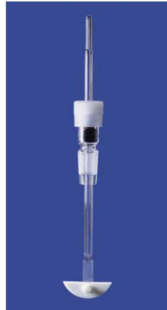
Hergestellt aus DURAN®-Rohr. Für Rundkolben von 250 - 2000 ml. Rührwelle, mit Rührblatt und Sicherungsschraube PTFE. Verschliesst Vakuumrührapparaturen gasdicht bis 10<sup>-3</sup> mbar bis zu einer Dauerbelastung von 800 Upm.
