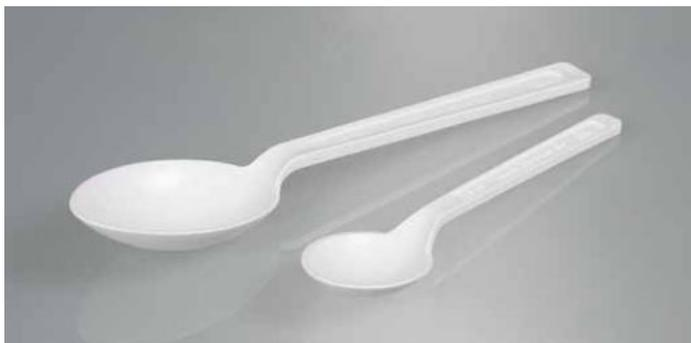
Die Probenlöffel sind ideal für die Probenahme von Pulver, Granulaten, Pasten und Flüssigkeiten. Der Bio-Kunststoff Green PE erfüllt alle zur Probenahme perfekt geeigneten Eigenschaften herkömmlichen Polyethylens, wird jedoch aus nachwachsenden Rohstoffen hergestellt und kann vollständig recycled werden.
