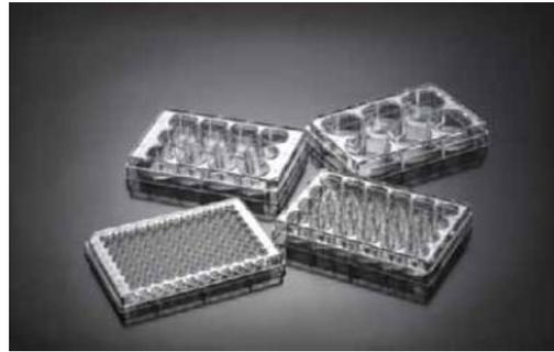
Zellkulturplatten mit behandelter Oberfläche für die Kultivierung von adhärenenten Zellen. Bedingt durch erhöhte Well-Ränder sowie einem Kondensationsring im Deckel ist die Verdunstung reduziert.
