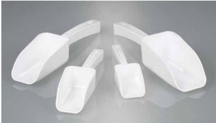
Sie sind ideal für Pulver, Granulate und Pasten. Der Bio-Kunststoff Green PE erfüllt alle zur Probenahme perfekt geeigneten Eigenschaften herkömmlichen Polyethylens, wird jedoch aus nachwachsenden Rohstoffen hergestellt und kann vollständig recycled werden.
