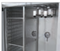
Trockenschrank mit geteiltem Innenraum und Aufhängung in Führungsschienen
