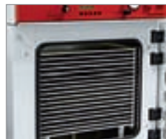
Vakuum-Trockenschrank mit speziellen Einschüben für große Anzahl besonders flacher Proben
