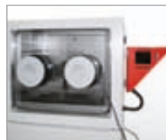
Klimaschrank mit Vollsichtglastür und Handdurchführungen
