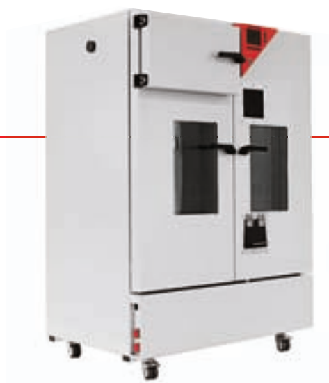
Klimaschrank mit zusätzlichen Fenstern, Türen und Durchführungen für Verbindung zu vielen Messinstrumenten
