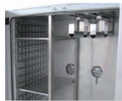
Trockenschrank mit geteiltem Innenraum und Aufhängung in Führungsschienen
