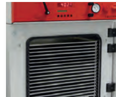
Vakuumtrockenschrank mit speziellen Einschüben für große Anzahl besonders flacher Proben
