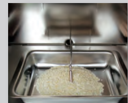
Objekttemperaturanzeige mittels PT 100 Föhler
