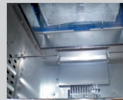
BINDER INDIVIDUAL FDL mit UV-Lampe für Tests von UV Beständigkeit
