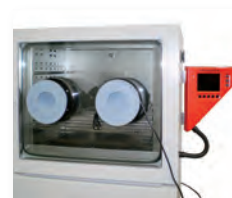
Klimaschrank mit Vollsichtglastür und Handdurchführungen
