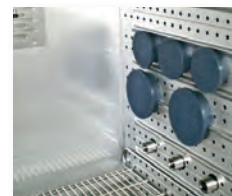
Klimaschrank mit verschiedenen Durchführungen für Verbindung zu vielen Messinstrumenten
