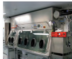
Vakuum-Trockenschrank an Glovebox
