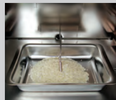
Objekttemperaturmessung mittels PT 100 Fühler
