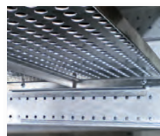
Umweltsimulations-Schrank mit verstärkten Innenkessel und verschraubten Lochblechen für besonders schweres Prüfgerät
