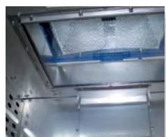
Sicherheits-Trockenschrank mit UV-Lampe für Tests von UV Beständigkeit
