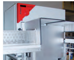
Trockenschrank in Bandbetrieb integriert
