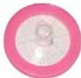
**6** LLG Spritzenvorsatzfilter *SPHEROS*, PTFE
